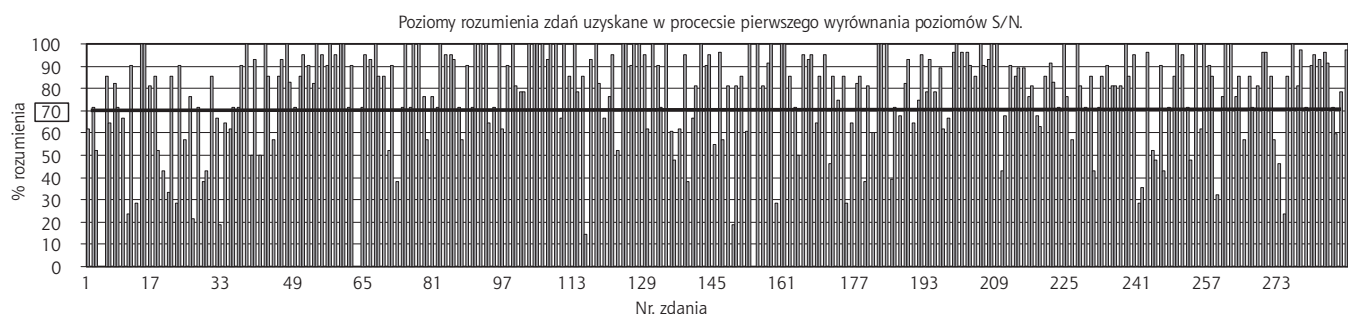
Ryc. 3. Rozumienie słów w próbce 273 wytypowanych zdań, przy stałym poziomie szumu równym 65 dBA. Wartość referencyjna ustalona została na poziomie 70%. W wieloetapowym procesie równoważenia zdań pod względem ich rozumienia, poziomy ciśnienia akustycznego zdań łatwych nieznacznie zmniejszano, a zdań trudnych nieznacznie zwiększano, dla uzyskania porównywalnego ich rozumienia.
