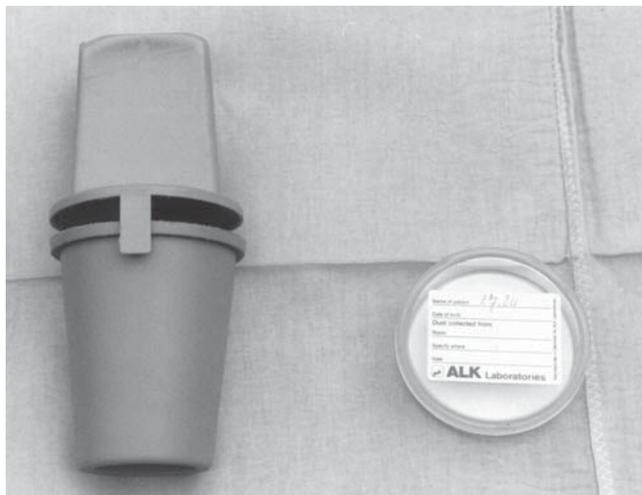
Ryc. 1. Urządzenie do zbierania kurzu (po lewej) i filtr, na którym osiada zbierany kurz (po prawej) przykryty płytką ochronną. W czasie zbierania kurzu filtr znajduje się wewnątrz urządzenia, które połączone jest z odkurzaczem.
