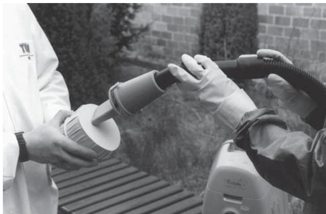
Ryc. 2. Metoda badania barierowości tkaniny. W pojemniku trzymany przez osobę po lewej i pokrytym badaną tkaniną znajduje się porcja 30 g kurzu. Podłączone do odkurzacza urządzenie zasysa kurz przez badaną tkaninę - kurz gromadzi się na filtrze wewnątrz urządzenia.
